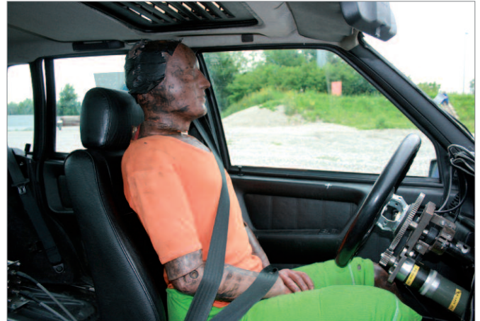
Bild 9: Dummi bei TB 11 Versuch gemäß ÖNORM EN 1317
