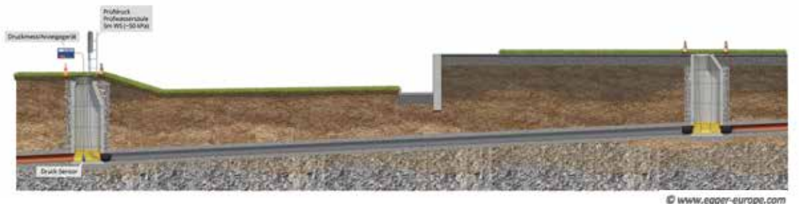
Bild 4: Dichtheitsprüfung – Rohrleitung (Wasser)
