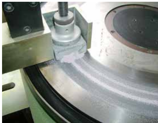
Abb. 4: XM1 Prüfung mechanischer Abrieb nach Böhme
