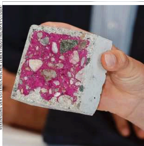
Stellt man im Labor die Rekarbonatisierung dar, sieht man an der Färbung die CO 2 -Aufnahme
